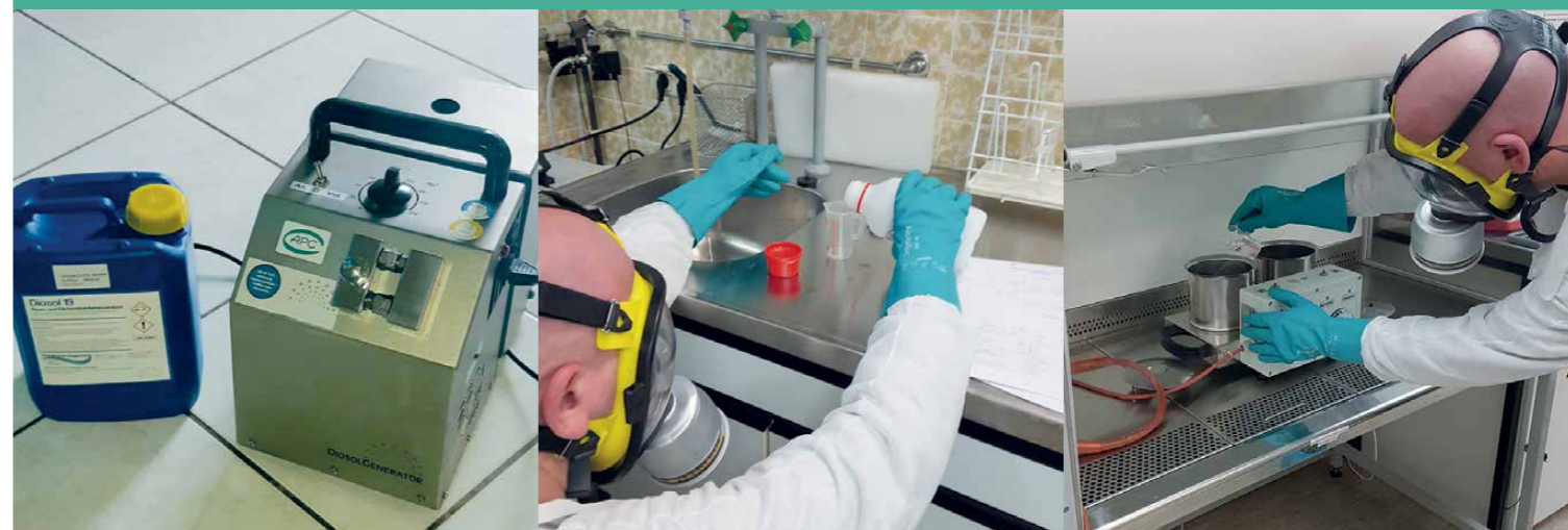
DiosolGenerator MF Professional zur Raumdesinfektion mit Wasserstoffperoxid im aHP-Verfahren mit dem Desinfektionsmittel Diosol19.
